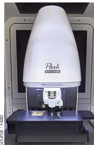
Microscope à force atomique utilisé par Filab pour visualiser la topographie de la surface d'échantillons.
